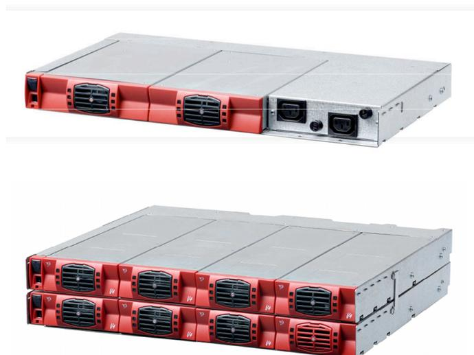
DC/AC инверторные системы 48/220 TSI Veda EPC Pack, предназначены для установки в 19" стойках и шкафах. Каждый модуль TSI VEDA имеет номинальную мощность 500 ВА / 400 Вт. В отличие от традиционных инверторов, инверторы TSI в режиме AC-AC осуществляют преобразование с двойной фильтрацией и изоляцией AC-входа. В режиме EPC полная эффективность увеличена до 93 % без потери качества и стабильности формы волны напряжения.
