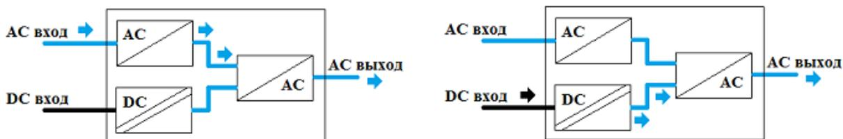
Чисто синусоидальная волна на выходе и идеальный коэффициент мощности на входе достигаются без использования энергии от источника постоянного тока. Компактность инверторной системы 48/220 TSI VEDA EPC Pack, возможность «горячей» замены DC/AC инверторов TSI VEDA EPC Module, встроенный статический байпас, а также распределение с входным и выходным автоматом делают данную инверторную систему идеальной для применения в телекоммуникационной и IT сфере.
