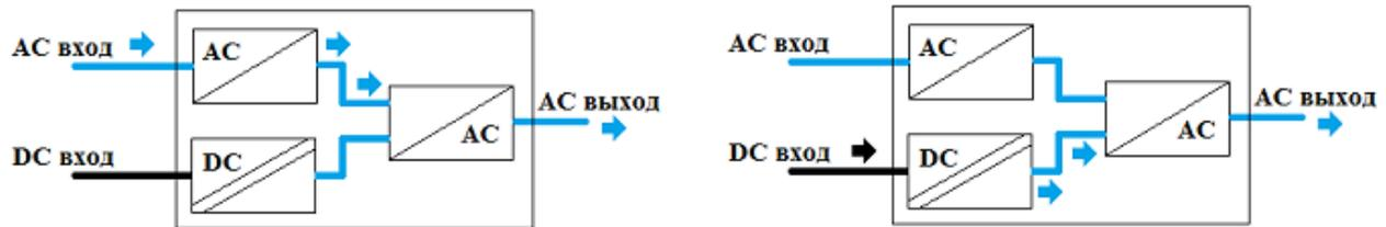
DC/AC инвертор 48/220 TSI Nova EPC Module / Module 10 представляет собой инверторный модуль для установки в 19"-систему TSI Nova EPC Pack (1U или 2U) рассчитанную на 3 или 6 DC/AC инверторов.
