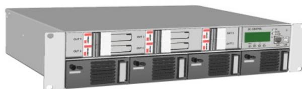
Типы BZX в 19" исполнении, высотой 1 U, 2U с контроллером, панелью распределения батарей и нагрузки
